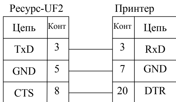
Рисунок Е.9 Схема подключения измерителя Ресурс-UF2 к принтеру фирмы EPSON с использованием сигнала готовности приемника
